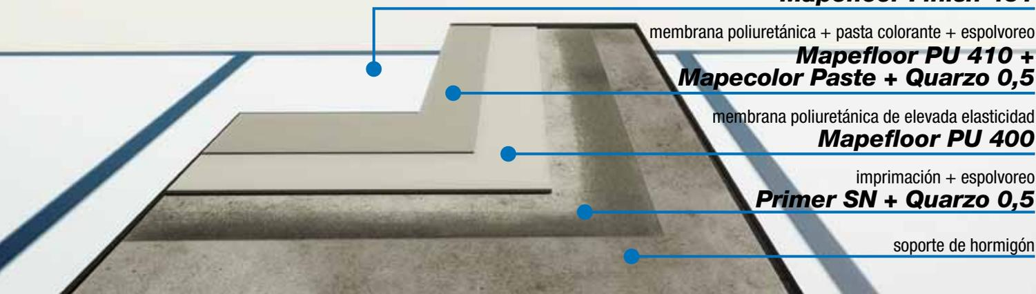
Sistema multicapa, altamente elástico, con capacidad de puenteo de fisuras (*crack bridging*) incluso hasta -20°C, antideslizante, coloreado, idóneo para superficies interiores y exteriores, impermeabilizante\*, dotado de una alta resistencia química y mecánica, para su uso en:
